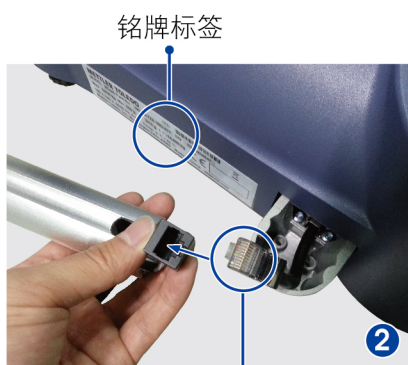
将水晶头插入立杆显示屏接口
